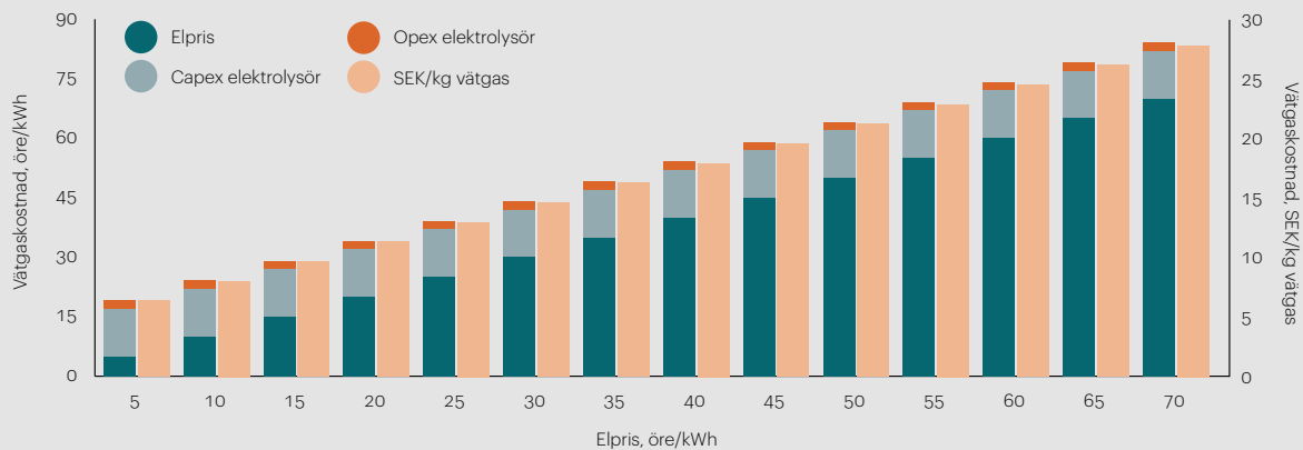
Figur 12: Räkneexempel för vad kostnaden på vätgas blir vid olika elprisnivåer, anges i öre/kWh respektive kr/kg vätgas. Indata; 8 Mkr/MWe för elektrolysör inkl. kringutrustning, 6 % kalkylränta och en avskrivningstid på 20 år. Beräkningen inkluderar inte något lager. Källa: IVAs projekt Vätgasens roll i ett fossilfritt samhälle, egna beräkningar.
