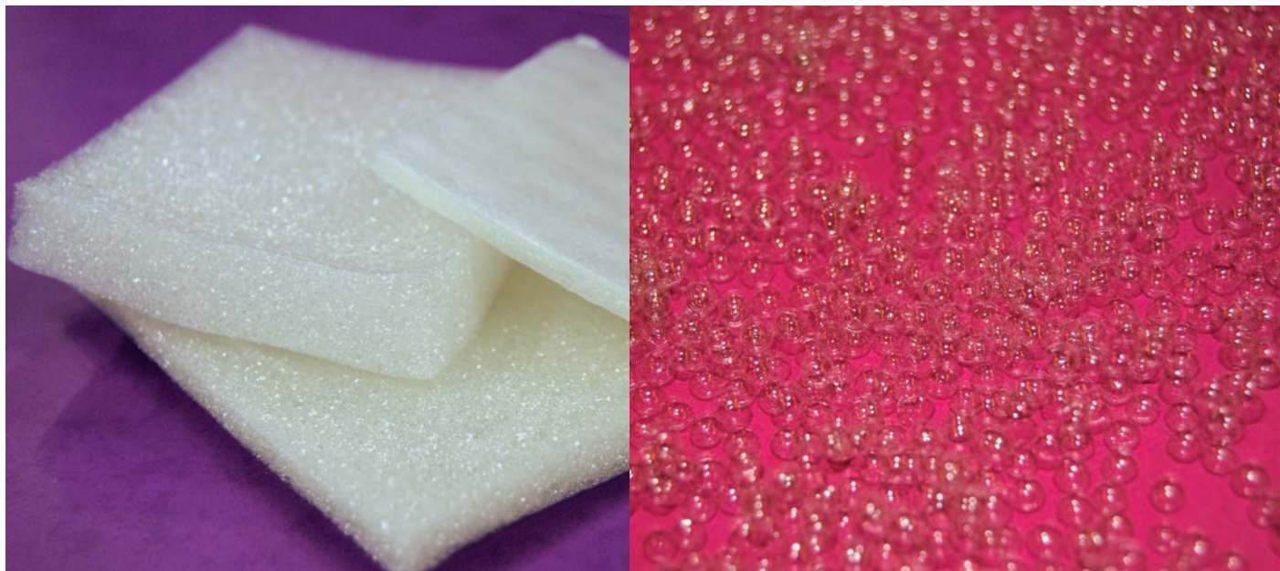
Cellulosaskum – ett mycket poröst material bestående av nanocellulosa. Ett av många material man fått fram av pappersmassa. Till höger håliga kulor av ren cellulosa.
