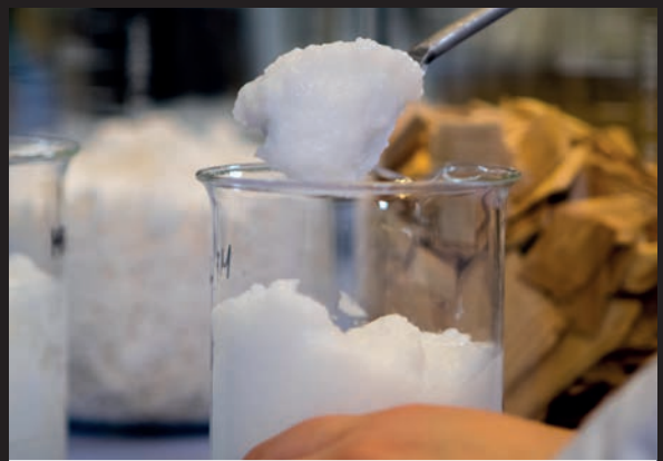
MFC, mikrofibrulär cellulosa, som också kallas nanocellulosa, kan användas som barriärmaterial som inte släpper igenom fett och syre. Forskare utvecklar nu materialet så att det ska kunna användas också som barriär mot vatten. Det skulle kunna ersätta både plast och aluminiumfilmer i olika typer av vätskekartong.
