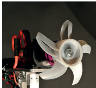
Boxpropellern monterad för test med realistisk hastighet, vilket motsvarar 70 procent av ljudets
