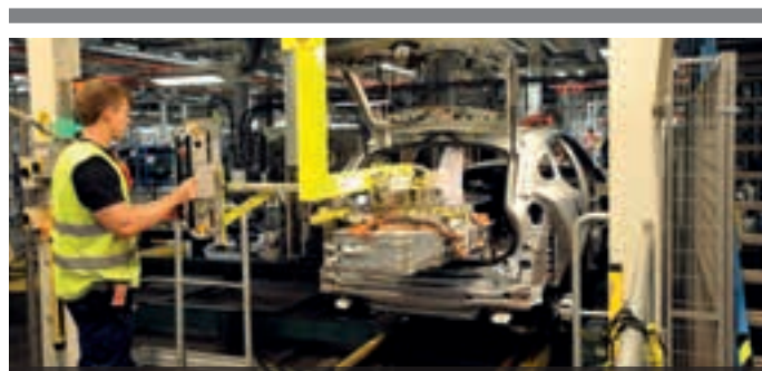
Erik Fjeelheim monterar ett 140 kilo tungt litiumjonbatteri i en Volvo V60 plug-in hybrid. Batteriet lyfts in i bagageutrymmet där det vänds 90 grader.
