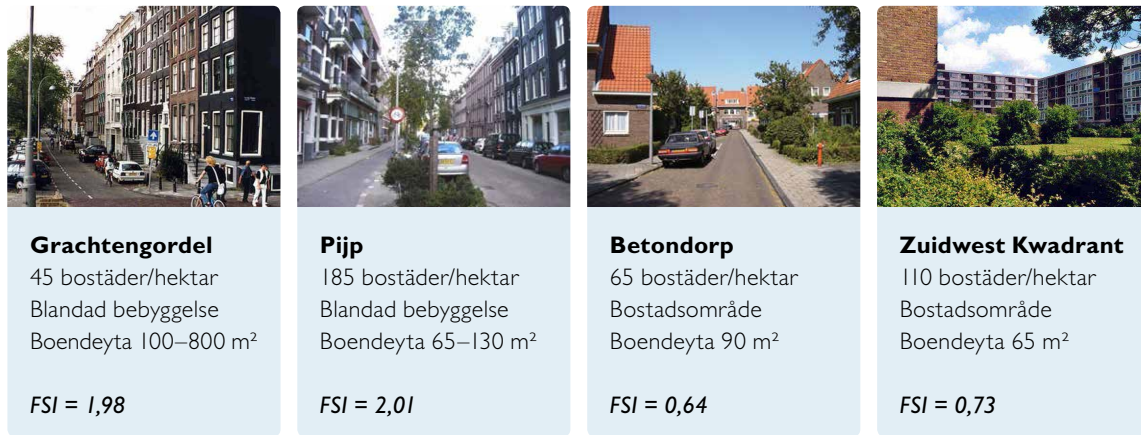
Figur 19: Fyra holländska stadsmiljöer med olika exploateringstal (FSI)*, olika storlek på lägenheter och olika avstånd mellan husen. Exemplet visar att en till synes gles förort (längst till höger) kan ha ett betydligt lägre exploateringstal än en tätbebyggd innerstadsmiljö (längst till vänster). Samtidigt kan den tillsynes glesa förorten hysa fler bostäder (men mindre) och därmed potentiellt sätt fler människor per ytenhet. 33
