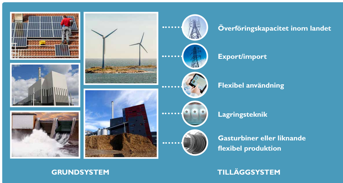
Figur 20: Illustration av hur analysen skiljer på "grundsystem" – produktionsanläggningar, och "tilläggsystem" – de tekniklösningar som krävs för att grundsystemet ska fungera.
