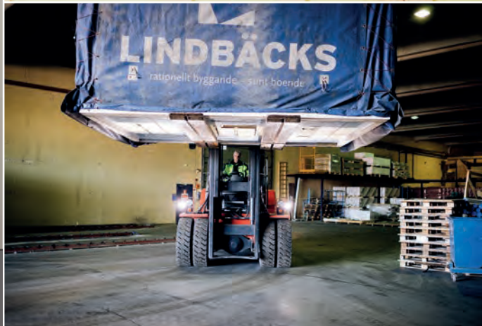
Målaren Olivia Flodström spacklar väggar och tak. Hon slipper spackla taket underifrån eftersom det byggs ihop efteråt. Allt monteras ihop efter hand i fabriken: golvläggning, kakling och klinkning, dragning av rör inom husmodulen, köksmontering och så vidare. Slutligen tar en truck ut husvolymen från fabriken.
