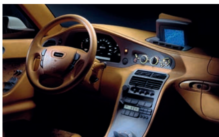
Navigeringssystemet Dynaguide gav föraren aktuell trafikinformation på en skärm på instrumentbrädan.
