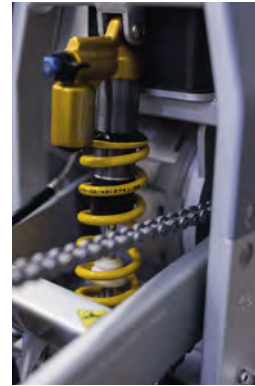
Nästan alla delar till elmotorcykeln är specialbyggda, inklusive stötdämparna från Öhlins.
